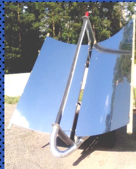
Fig.1. Saules enerģijas gaisa sildīšanas kolektors ar enerģijas koncentratoru: a) – ierīces shematiskais attēls; b) – ierīces FOTO
