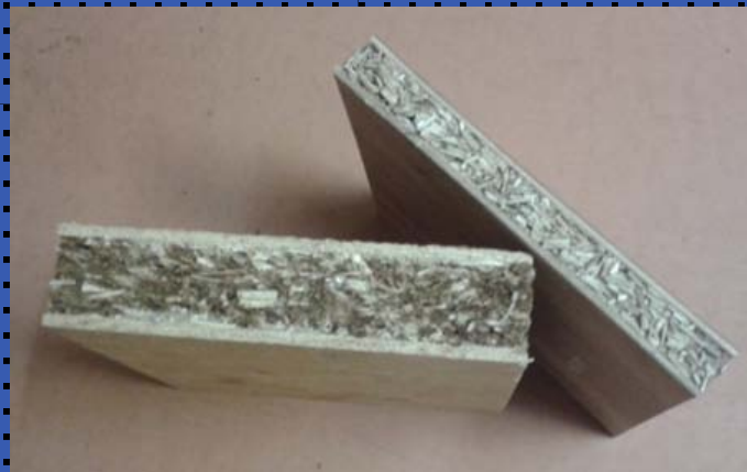
Att. Kaņepju celtniecības-izolācijas plākšņu eksperimentālie paraugi
